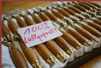
Jede Klara wird in unserer Manufaktur von Hand montiert, mit natürlichem Hanf abgedichtet und nach der Funktions- und Dichtheitsprüfung sorgfältig verpackt.
